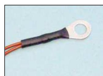
Zum Abschluss wird diese Masseleitung mit den beiden, vom Motorkabelbaum kommenden, Massekabel an den Masse-Anschraubpunkt verschraubt.
