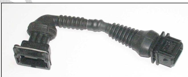
Die Gegenseite des Adapters wird an den Stecker des Drosselklappenschalters gesteckt.
