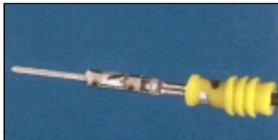
Ankrimpen der Einzeladerab- dichtung bei AMP Super-Seal
